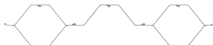
Коробчатые шпунтовые сваи (из 2 свай ESC-HRZ и 1 свай U-типа)
